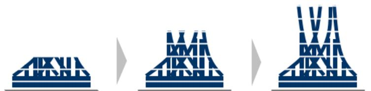
Bei additiven Fertigungsverfahren werden Bauteile auf CAD-Datenbasis schichtweise aus feinstem Pulver hergestellt. Die Herstellungsprozesse zeichnen sich durch eine sehr hohe Flexibilität und völlig neue Designfreiheiten aus. Bauteile werden in kürzester Zeit und mit hervorragenden mechanischen Eigenschaften produziert.
